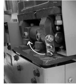
(fig 16) Den lille låsen, er en plate med to hettemuttere som må flyttes senke bordet.
